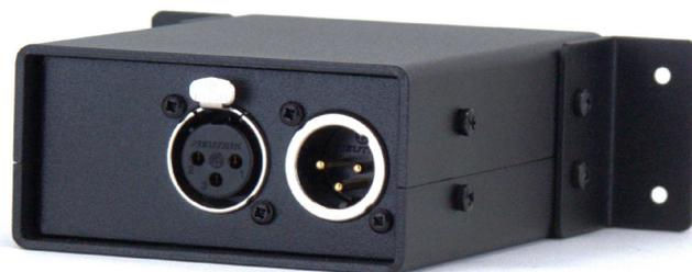
BP100F ist ein für öffentliche Dienste entwickelte Einkanal-Intercomstation für bedienfreundliche Kommunikation ohne inherente Verzögerung. Die Station nutzt die international übliche Partyline Topologie und ist damit kompatibel mit allen solchen analogen Systemen.
