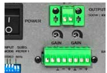
Besonderheit des Verstärkers AX2500-2TS sind, wie vorher erwähnt, die **Prioritätseingänge pro Kanal**. Beachten Sie bitte, dass bei diesem Verstärker zwei Eingänge pro Kanal vorhanden sind, und zusätzlich noch je ein 24-V-Steuerspannungseingang. Der zweite Kanaleingang ist für Notdurchsagen in komplexen Systemen, wie Flughäfen, Einkaufszentren, Stadien, usw. gedacht.
