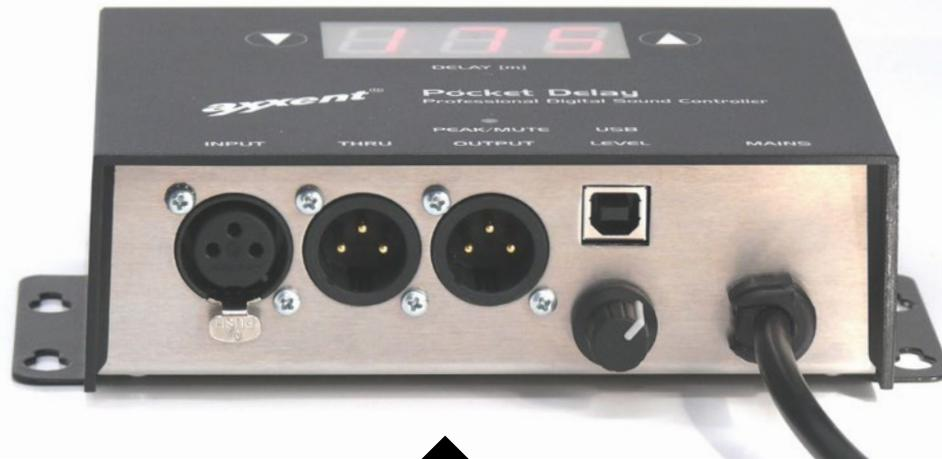
Das axxent Pocket Delay kann ein Tonsignal sowohl zeitlich verzögern als auch bearbeiten. Vorwiegend ist die Anwendung vor Endstufen oder aktiven Lautsprecherboxen. Es lässt sich mittels Befestigungsglaschen auf der Rückseite von Lautsprecherboxen oder auch als kleines Tischgerät verwenden.
