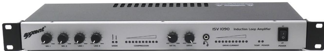
Der Verstärker dient dem Ansteuern von im Raum verlegten Kabelschleifen. Die Kabelschleifen erzeugen ein Induktionsfeld, das von in Hörgeräten vorhandenen Spulen empfangen wird. Das eingespeiste Tonsignal ist für die Träger von Hörgeräten in der Regel hochwertiger als das akustische Signal aus dem Raum, das ansonsten über das Hörgerät verstärkt wird. Dies resultiert aus dem sehr breitbandigen Frequenzsignal und auch aus der Kompression, die von dem Induktionsschleifen-Verstärker übertragen wird.
