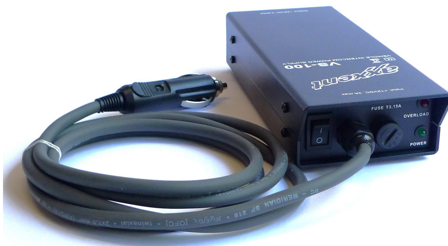
Bild: VS100C mit Stecker für KFZ-Zigarettenanzünder. Typ VS100 mit 2 m Kabel ohne Stecker
