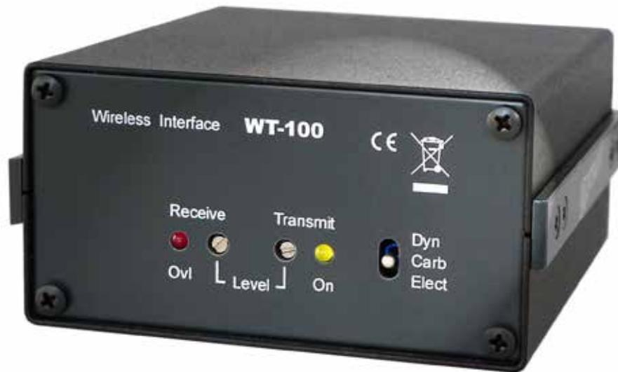
Der Adapter WT100 dient der Sprachverbindung von Handfunkgeräten (Walkie-Talkies) zu axxent Intercomsystemen. Der WT100 eignet sich für alle Handfunkgeräte, die einen externen Mikrofon- und Ohrhöreranschluss besitzen. Damit wird eine Sprechverbindung zwischen dem stationären Intercomsystem am Aufführungsort und Personal, das mit Handfunkgeräten unterwegs ist, erreicht.
